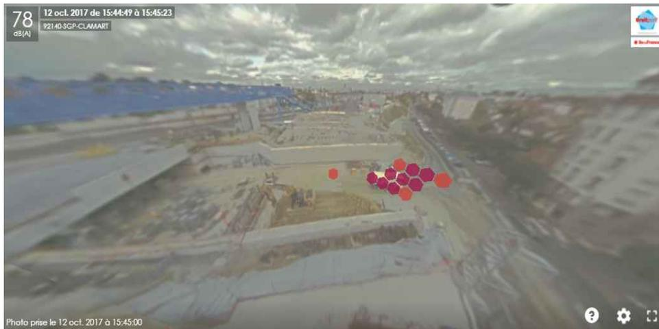
*L'une des images issues du capteur « méduse » déployé au niveau du chantier de la future gare du Grand Paris Express de Fort d'Issy-Vanves-Clamart. Elle montre que l'essentiel de l'énergie sonore émise à 15h45 le 12 octobre 2017 vers ce capteur provient d'un endroit précis du chantier (hexagones en rouge). Le niveau de bruit observé au niveau du capteur est par ailleurs de 78 dB(A).*
